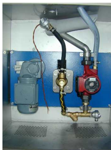
Heizkreislauf und Antrieb VGI Tischfass
