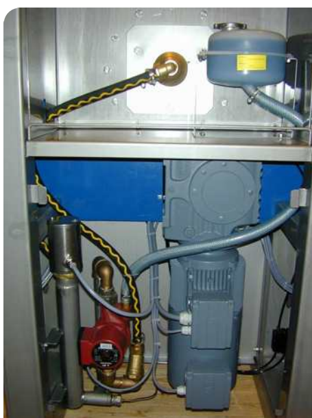
Heizkreislauf und Antrieb dose VGI
