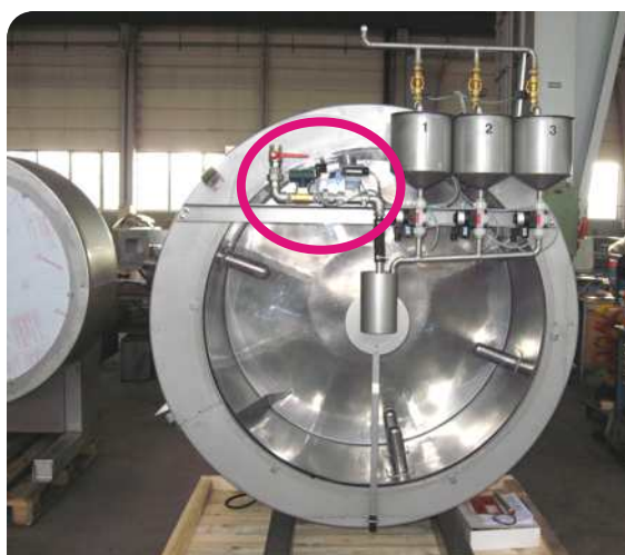
Wassermisch- und Dosieranlage
