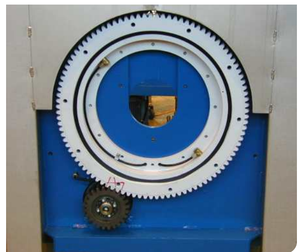
Motorhalteplatte mit Antrieb und Zahnkranz
